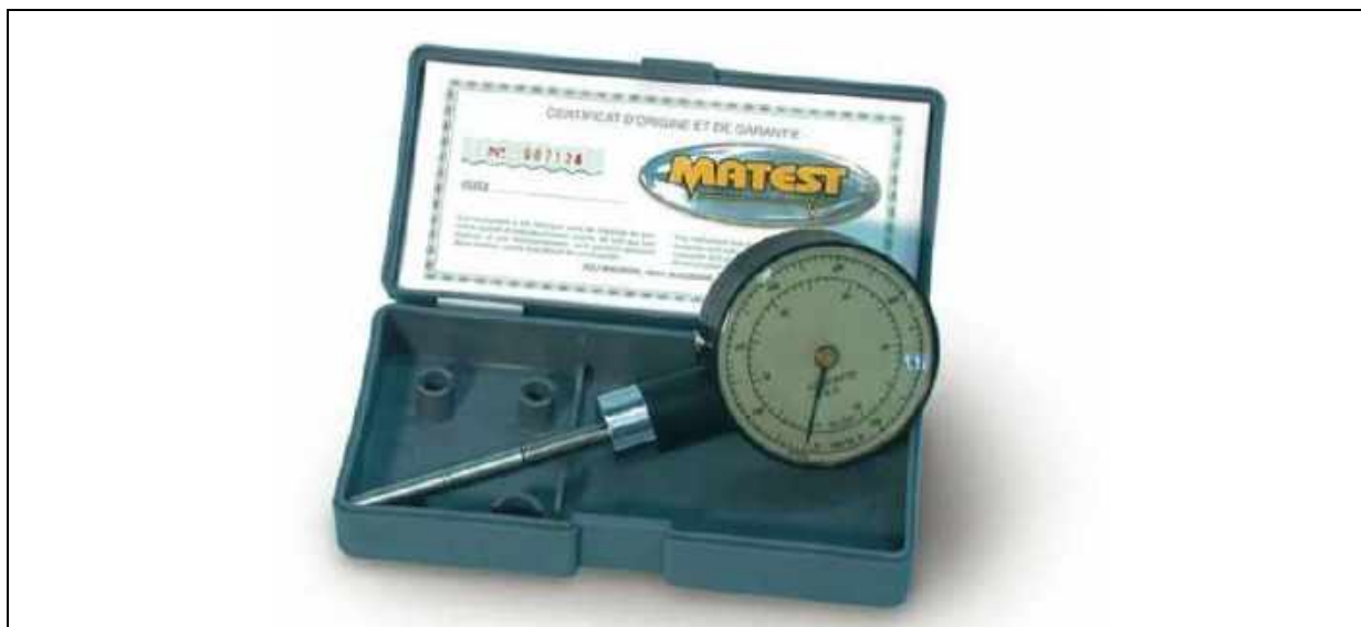
Figura 29 – Immagine rappresentativa di un penetrometro tascabile
