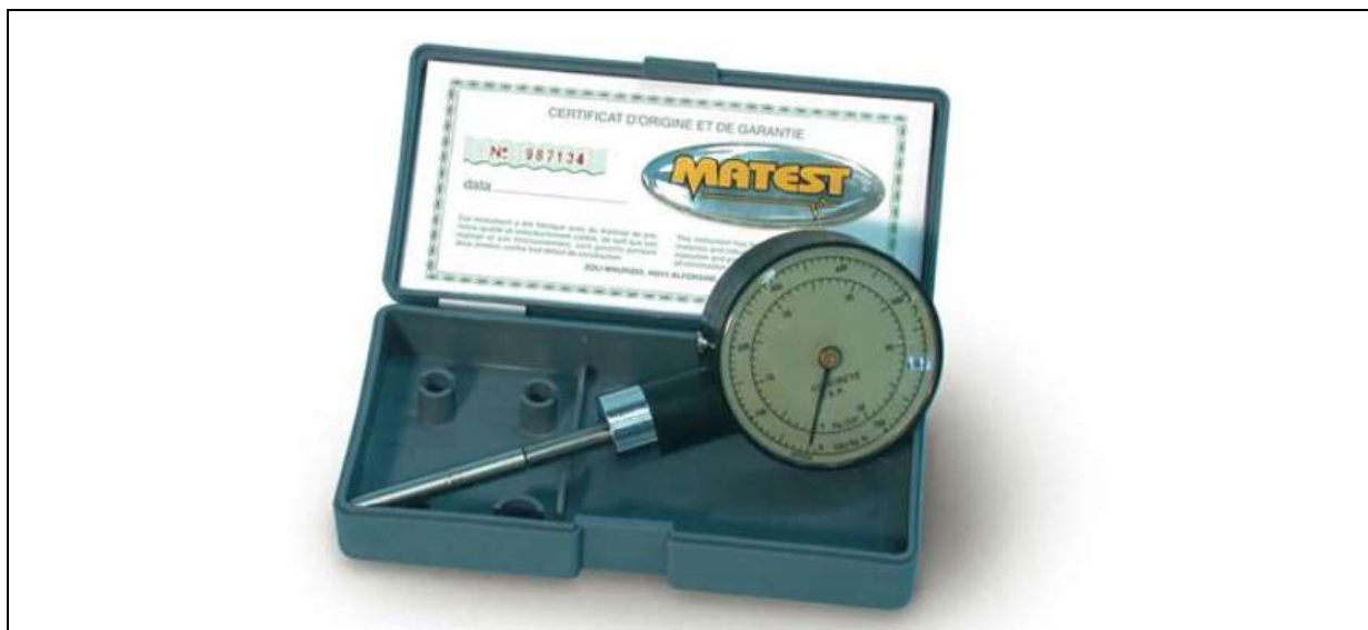
Figura 29 – Immagine rappresentativa di un penetrometro tascabile
