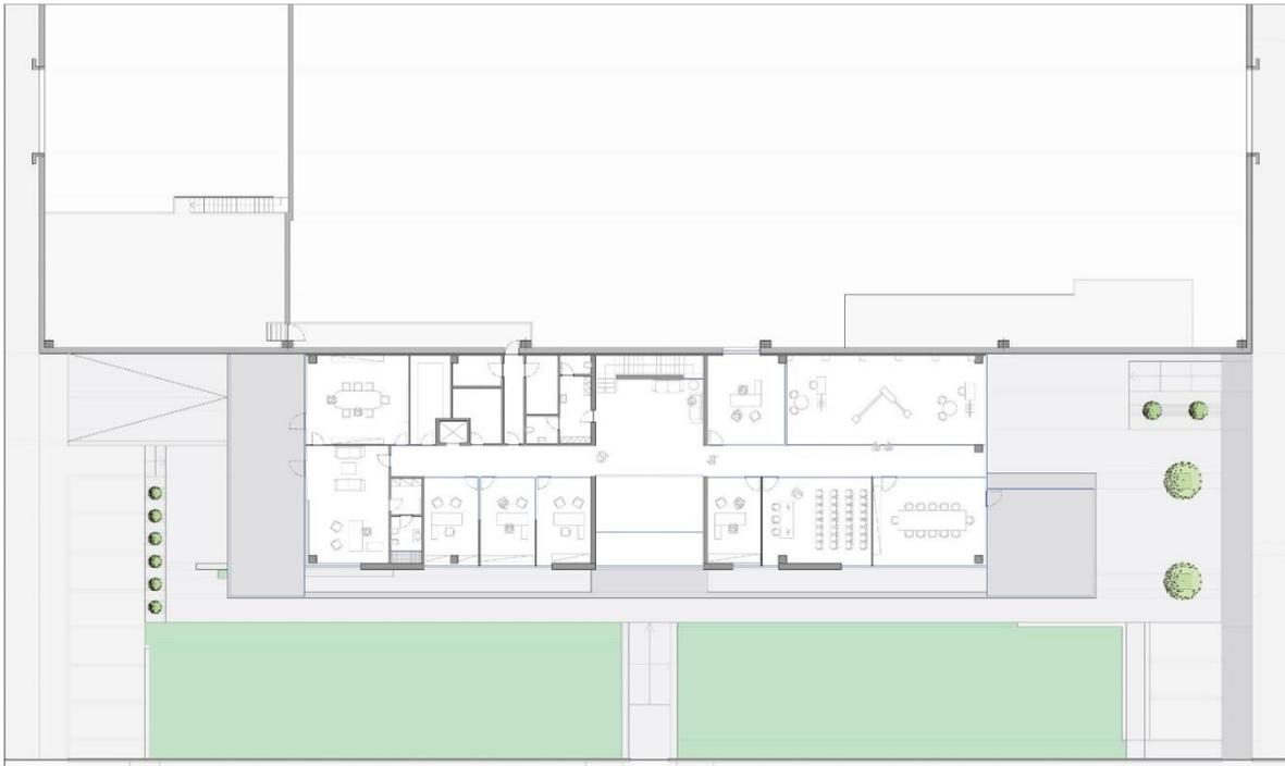
Dietro al front office, nascosta da un setto, è situata la scala di accesso al piano superiore che permette di giungere ad un atrio che si affaccia tramite la doppia altezza sull'ingresso sottostante. A copertura di tale area si trova un grande lucernario che permette di rendere particolarmente luminoso l'ambiente sottostante.
