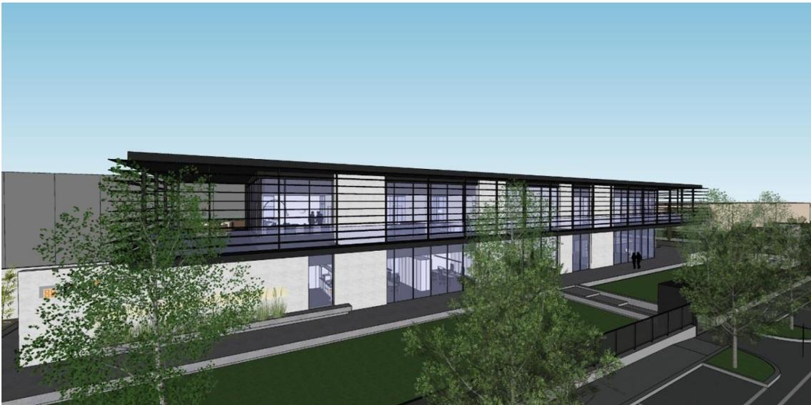
Tra le due cornici orizzontali vi è una schermatura solare realizzata tramite delle lamelle orizzontali che caratterizzano il piano superiore dell'edificio contribuendo a darne una percezione unitaria, omogenea e monolitica. Il volume superiore dato dalle due cornici e dal rivestimento a lamelle sembra infatti poggiare su quello inferiore. Oltre a una funzione estetica le lamelle svolgono anche un importante funzione di filtro solare per le retrostanti vetrate.
